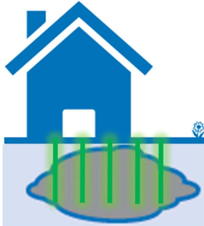
Durch Bohrungen werden unsere aktiven Mikroorganismen direkt an verschiedenen Stellen innerhalb der Kontaminationsfahne eingebracht.
